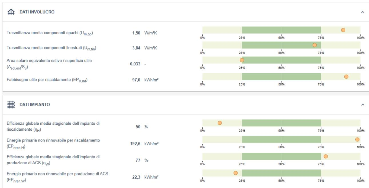
Figura 3. Interfaccia del servizio benchmarking e scenari di retrofit: analisi di benchmarking su alcune variabili progettuali
